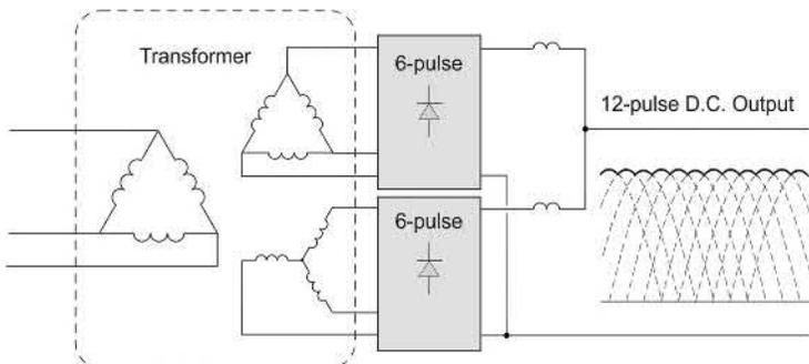
FIG. 7.17 Basic 12-pulse rectifier arrangement.
