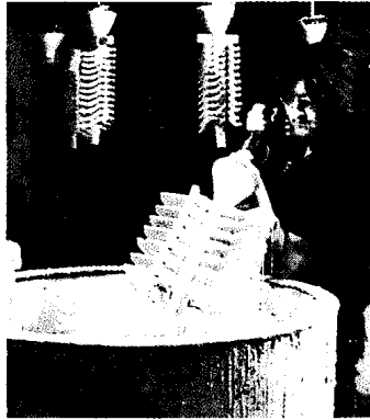
النموذج الشمعي يُفصل عن القالب ويُغمس في سائل خزفي حتى يغطي النموذج بطبقة رقيقة.
