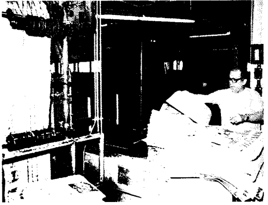
صحيفة يومية جاهزة تنقل بواسطة الحزام الناقل المتحرك إلى غرفة البريد حيث تنتظر شاحنات التسليم.
