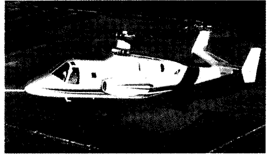
الطائرة المروحية التجريبية المركبة تستخدم مرواح متحدة المحاور تحقق لها قوة الرفع المطلوبة بالإضافة إلى وجود محرك لثبات يعطيها قوة الدفع إلى الأمام، ويماكان هذه الطائرة الوصول إلى سرعات تفوق سرعة الطائرة المروحية العادية.
