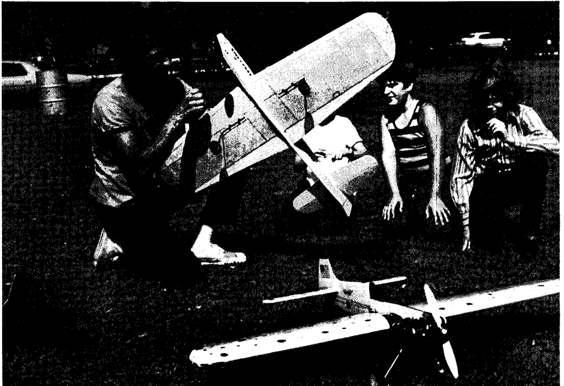
نموذج طائرة تطير بالتحكم الخطي، متصل بها أسلاك طويلة. ويتحكم الفرد في طيران هذه الطائرة بالإمساك بهذه الأسلاك أثناء طيران النموذج من حوله.
